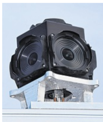
16 Kameras sind auf dem Dach des Autos verteilt.
