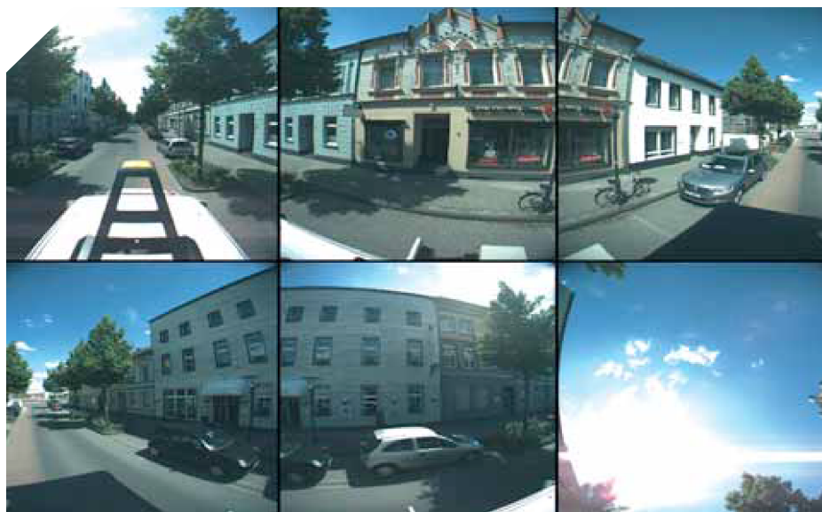
Die Kamera mit sechs Objektiven nimmt zeitgleich Bilder auf. Daraus werden die 360-Grad-Panoramen entwickelt.
